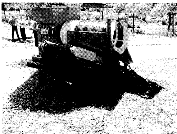
Фигура: 6 Барабанно сито, предвидено за употреба и на двете съоръжения за компостиране
